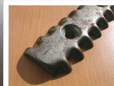
新品が2日後には摩耗してしまっただけの、従来の破碎刃。
